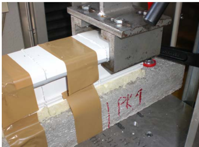
Bild 7 Prüfaufbau zum Zugversuch
